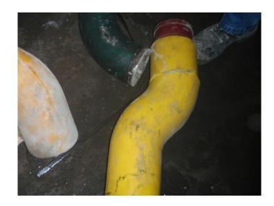
Ausbeulungen wie in der folgenden Aufnahme ersichtlich, zeigen einen baldige Durchabrasion der Betonaustragvorrichtung an, die normal ist und keine Gefahrensituation darstellt. Wenn die Betonaustragvorrichtung dieses Erscheinungsbild aufweist ist sie in Kürze zu ersetzen und daher ist eine neue Betonaustragvorrichtung als Ersatz bereitzuhalten um Betriebsunterbrechungen zeitlich so kurz als unbedingt notwendig halten zu können.
